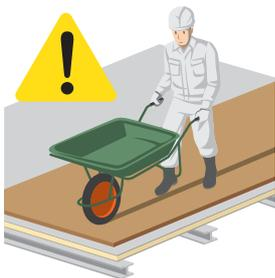
パネル上では台車による資材運搬は避けてください。やむを得ず運搬する際は、必ずコンパネ等を敷いた上で運搬時の荷重が面荷重の許容値以下となるようにしてください。また、運搬中は段差などで衝撃が生じないように注意してください。
