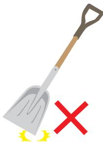
パネル上部に積もった雪下るしには、プラスチック製の角型スコップを使用してください。金属製スコップや剣先スコップはパネルを傷つけて、漏水発生の原因になります。
