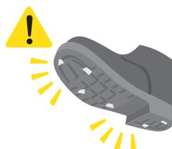
施工完了後のメンテナンスの際は、パネルを傷つけないよう靴の裏側が柔らかいこと、金属片や小石などが付着していないことを確認してから行ってください。
