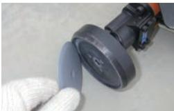
1 先端治具を取り付けた本体に、ディスク板を取り付けます。
