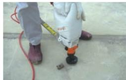
2 本体を下方に押し込むとエアの力で釘が打ち込まれます。
