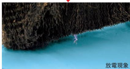
施工後のシートに傷がある場合、電流はアースされた躯体と電氣的につながっているアルミクロスシートを通して流れます。このとき放電現象が現れ、シートの傷が発見できます。
