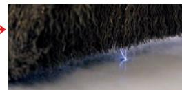
施工後のDNシートに傷がある場合、電流はアースされたDN鋼板と電気的につながっているアルミクロスシートを通って流れます。このとき放電現象が現れ、DNシートの傷が発見できます。
