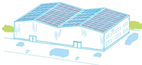
広い屋根を持つ倉庫は、ソーラーシステムを設置し発電を行うのに適しています。しかし、倉庫は柱の数が少なく、屋根の上に重いものを設置するような構造とはなっていません。
